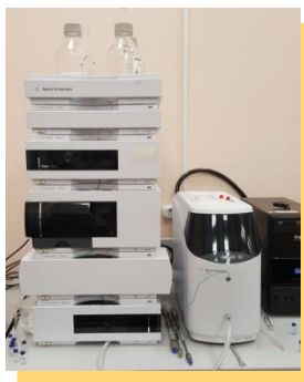
А 4.1 Хроматограф жидкостной «Agilent 1200» с УФ-детектором на основе диодной матрицы и детектором по светорассеянию (ВЭЖХ-УФДМ и ВЭЖХ-СР)
