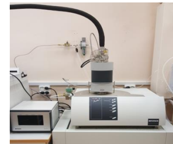
A8.1 Система синхронного термического анализа (термогравиметрия и дифференциальная сканирующая калориметрия) NETZCH Jupiter 449 F5
